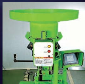
ボール自動供給装置
