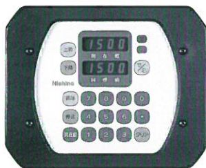
プリセット装置(オプション) 自動定盤の自動位置決め機能
